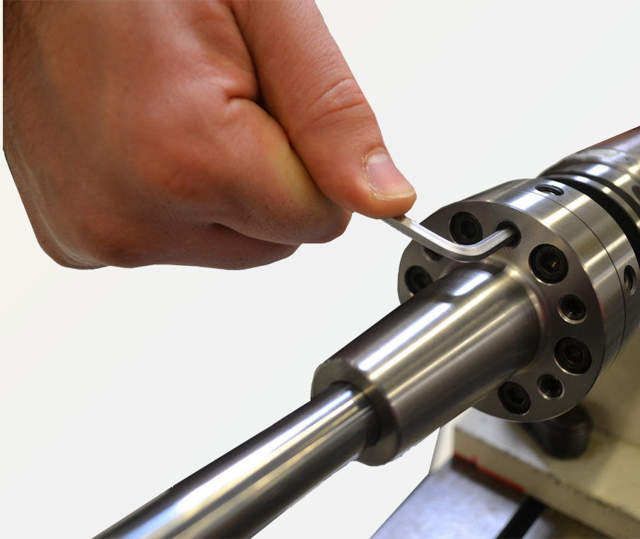
配图 17：采用角度调整螺栓调整角度
