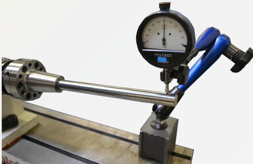
配图 14：将千分表安装到前部同心度检查位置
