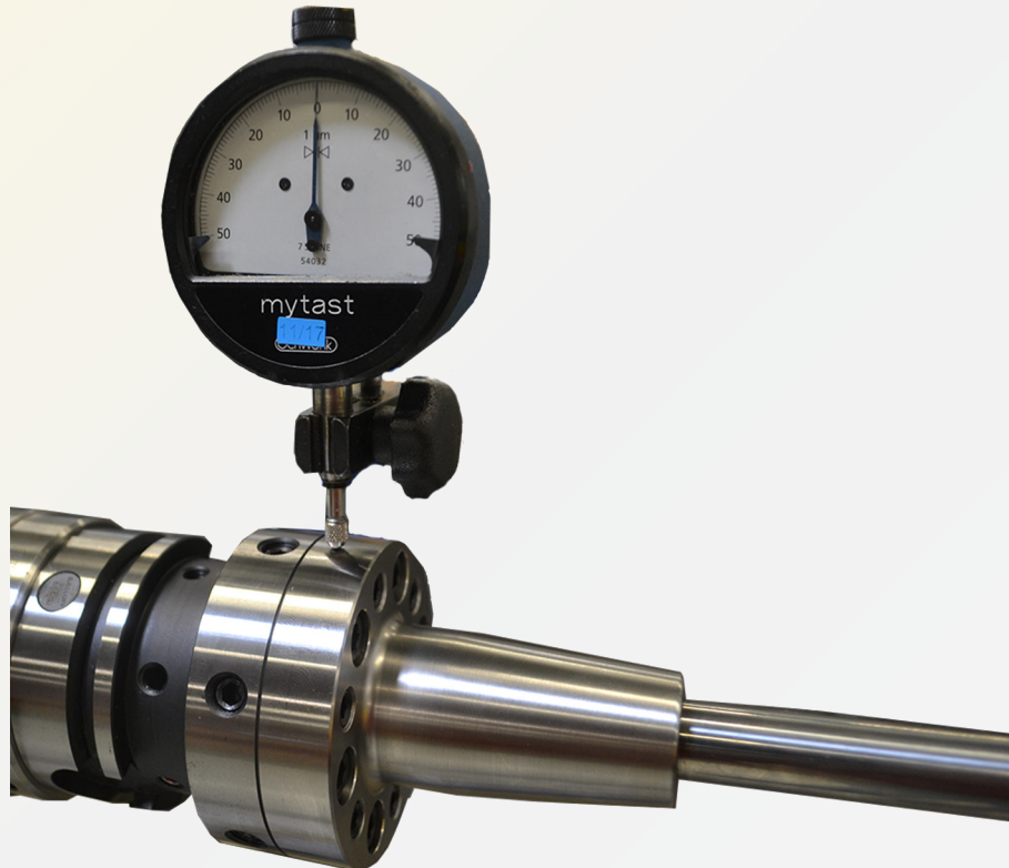
配图 18：检查模块法兰的径向调整情况
