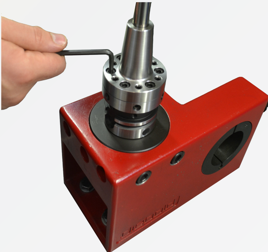
配图 6：稍微拧紧紧固螺栓
