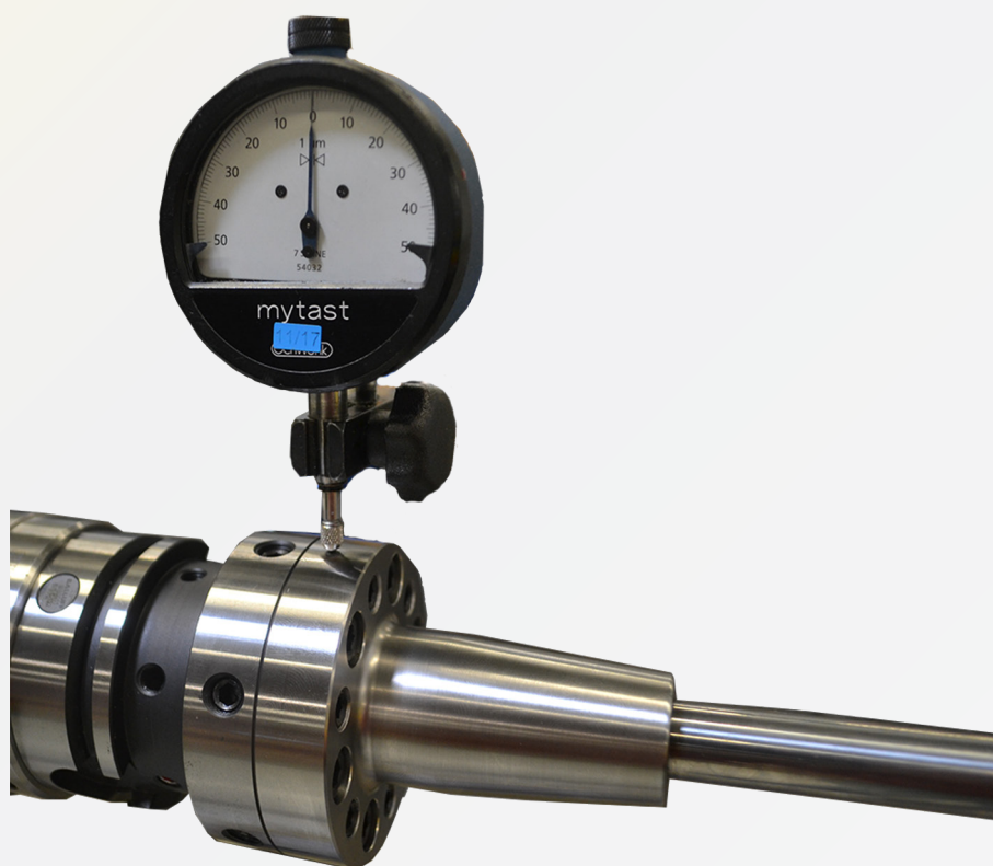
配图 8：将千分表安装到同心度检查位置处
