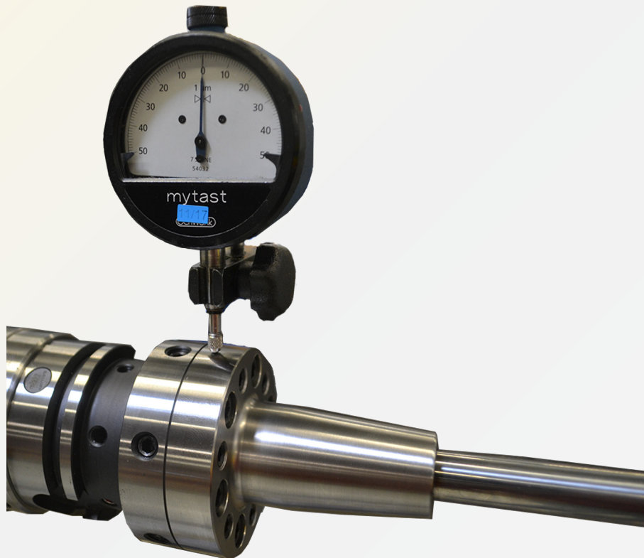
Fig. 18: Controlar la alineación radial del radial del módulo brida
