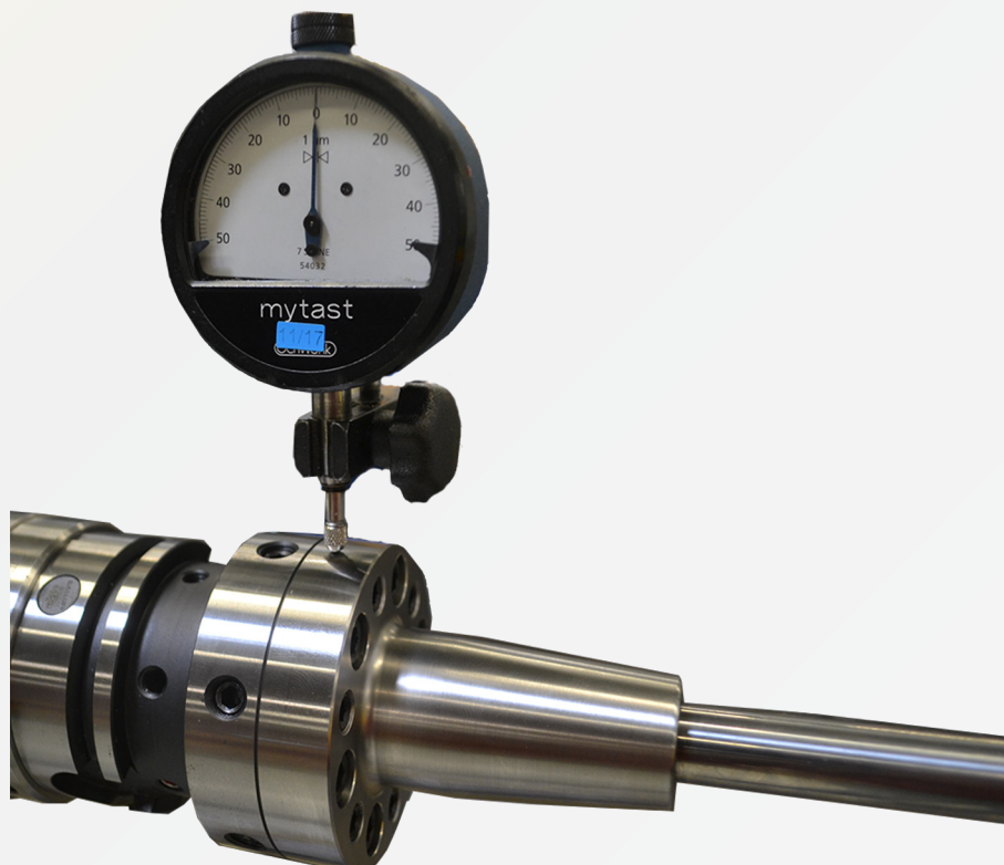
Fig. 8: Colocación en posición del instrumento de medición en el punto de control de la marcha concéntrica
