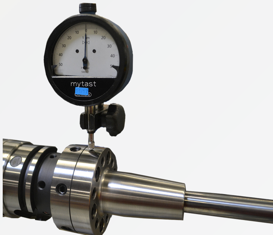
Fig. 10: Puesta a cero del instrumento de medición
