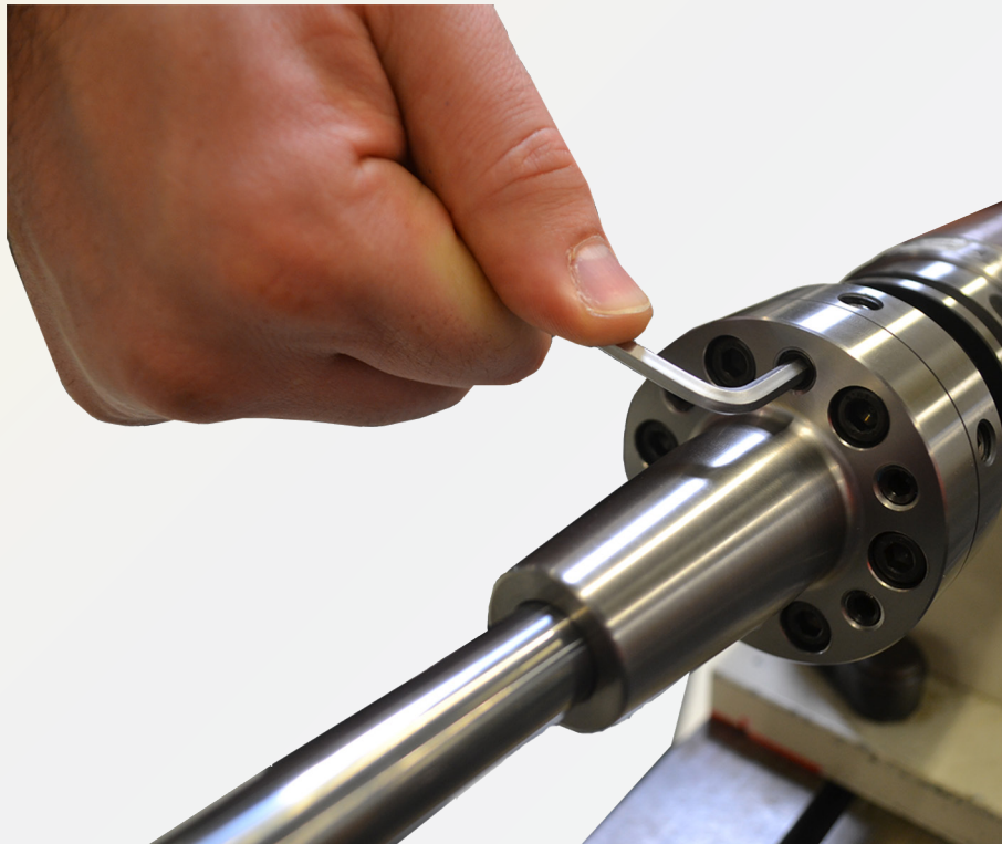
Fig. 17: Alinear el ángulo con los tornillos de ajuste de ángulo
