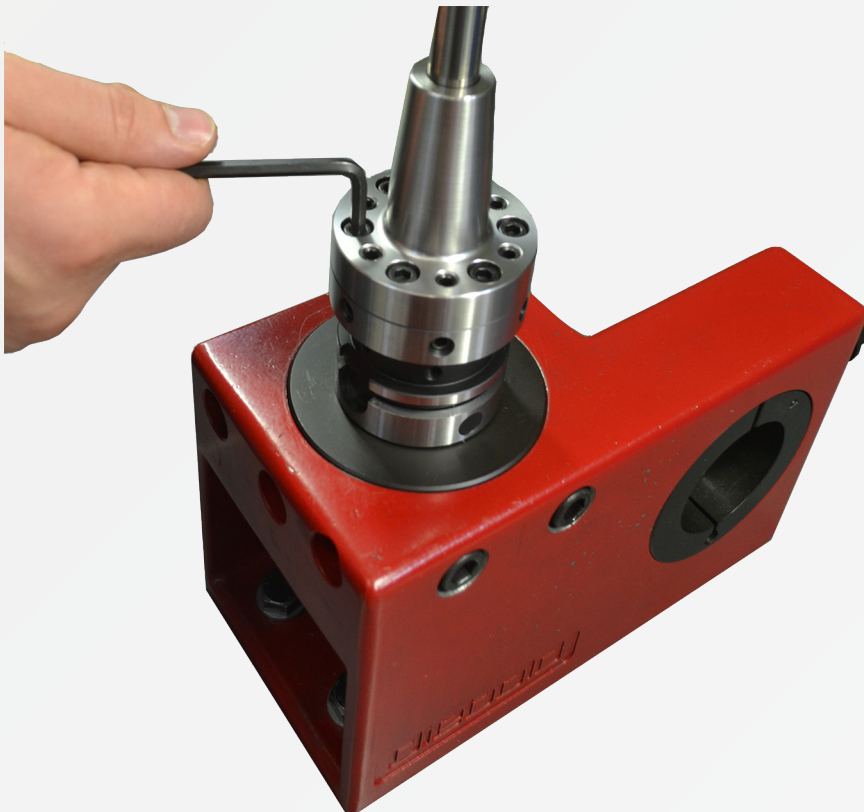
Fig. 6: Apretar ligeramente los tornillos de sujeción
